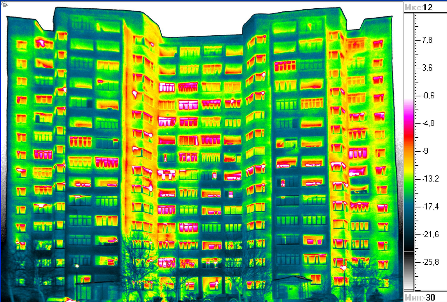
Панорамное термоизображение жилого дома (5x5 термограмм) 24
